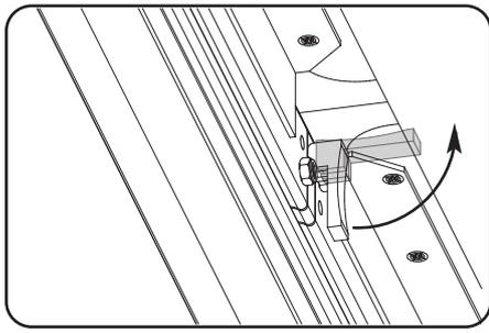
Bremshebel von unten lösen
