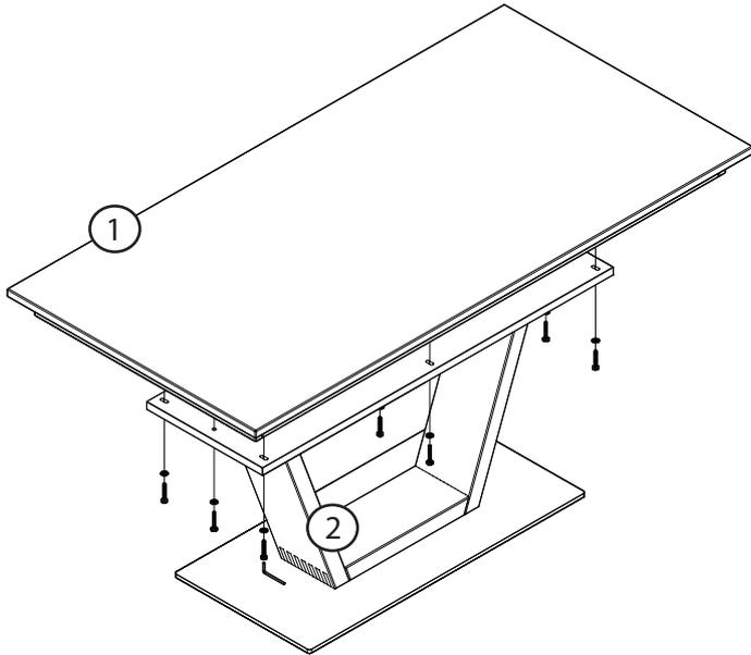
Den Oberbau ① auf den Unterbau ② auflegen und anschließend ausrichten
