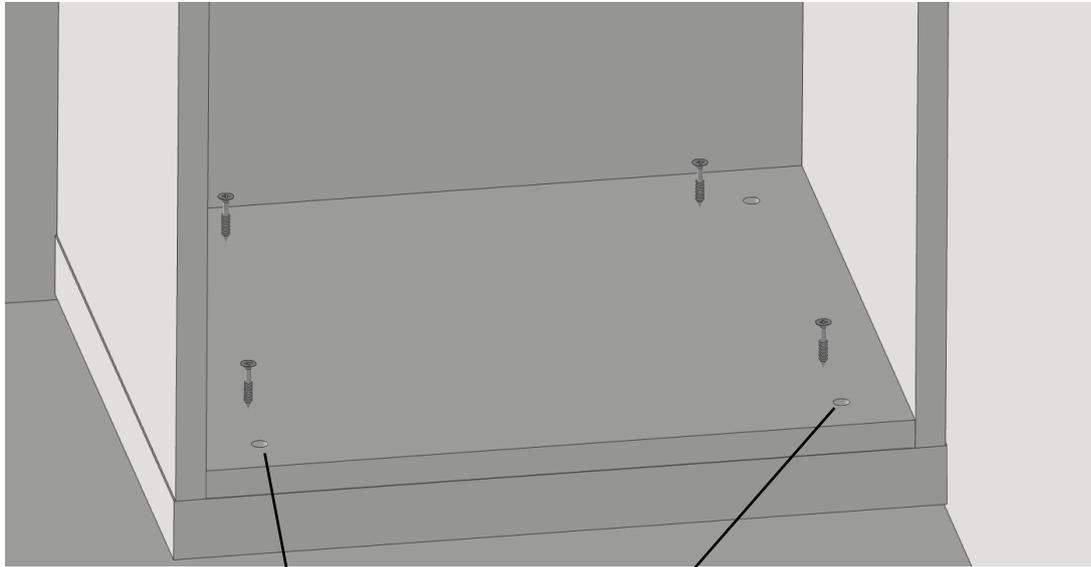
Löcher in Unterboden zur nachträglichen Ausrichtung
