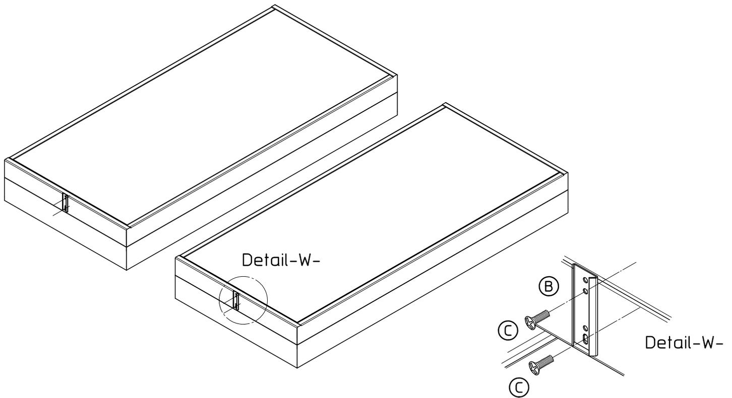
**Aufbau – Schritt 2 –** FüÙe, Verbinder montieren
