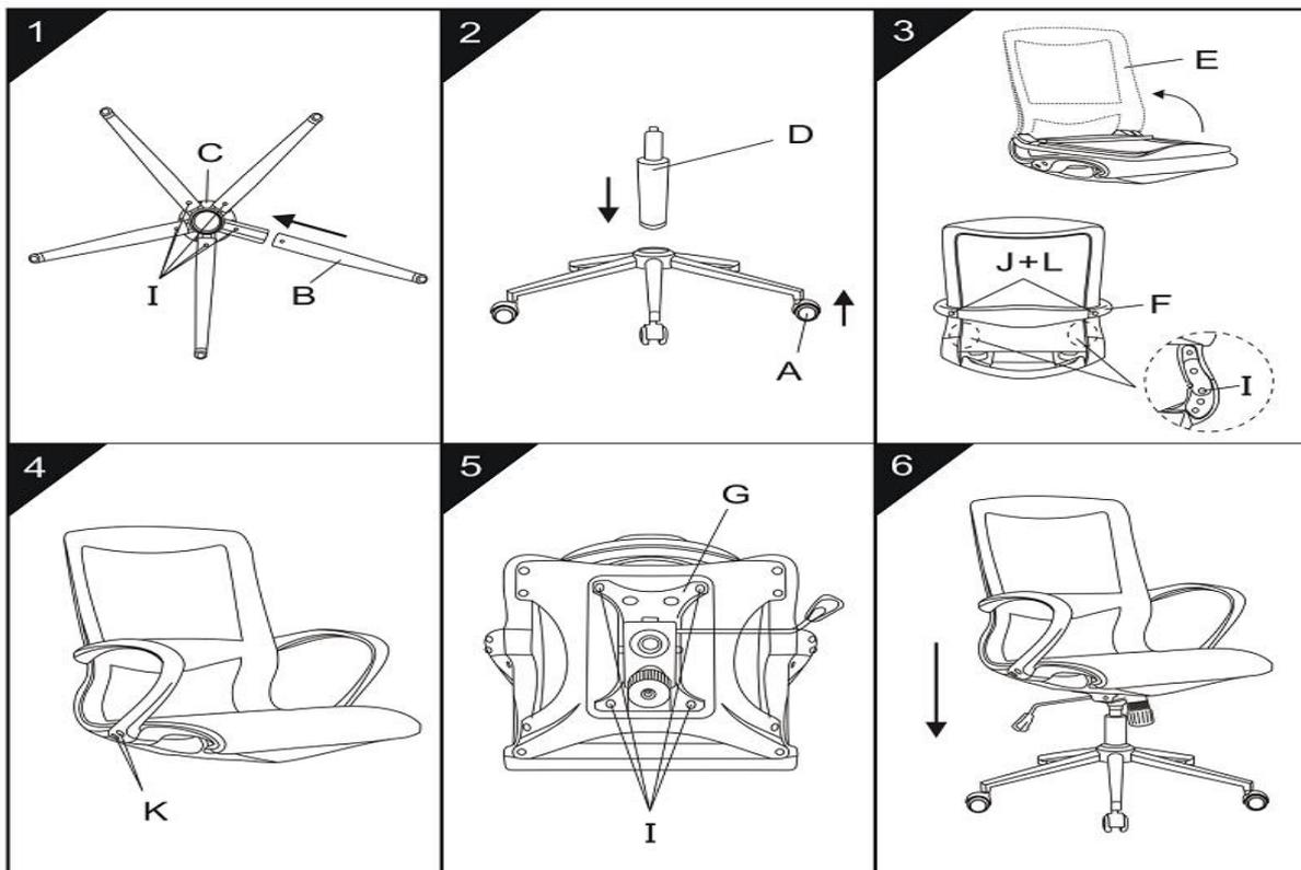
Nach der Montage setzen Sie sich bitte mehrfach hintereinander auf den Drehstuhl, damit sich die Verbindung zwischen Sitz, Gaslift und Fusskreuz verfestigt.
