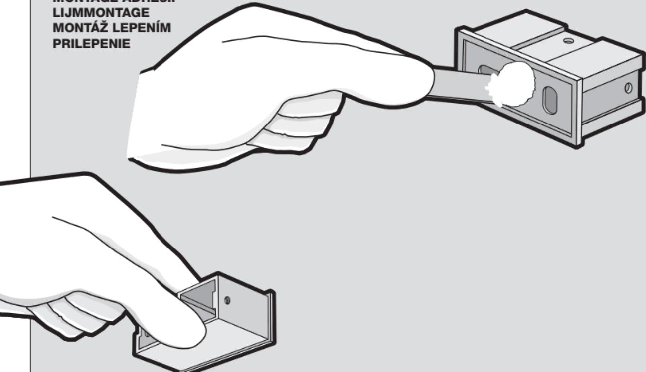
**D:** Angemischtes ZackMount-Haftmittel mit dem Spatel mittig auf die Montageplatte auftragen. Für die Verarbeitung des Klebers (nicht im Lieferumfang enthalten) beachten Sie bitte die dem Kleber beiliegende Bedienungsanleitung.
