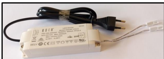
Elektronisches Vorschaltgerät (EVG)
